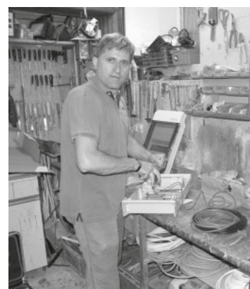
Klaus Jehle beim Bau des Elektroverteilers
